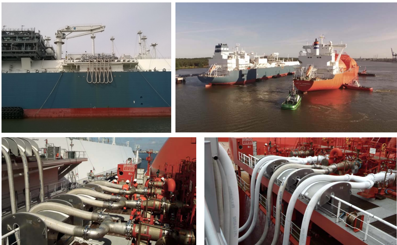
Sl. 1.2-1: Kriogene fleksibilne cijevi, proces peljarenja UPP broda i privez, spajanje fleksibilnih cijevi, vodena zavjesa tijekom pretovara UPP-a 11
